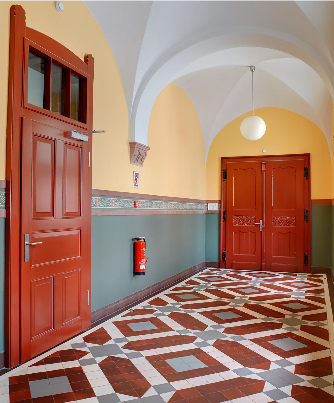
Sollten Sie ein denkmalgeschütztes Gebäude umbauen oder sanieren, fertigt Heep neue Innentüren mit an den Bestand angepassten Proportionen und Profilen an. Auch bei erforderlichen Nachweisen für z.B. Brand-/Rauchschutz, Schallschutz oder Einbruchhemmung können Elemente ansichtsähnlich gefertigt werden.
