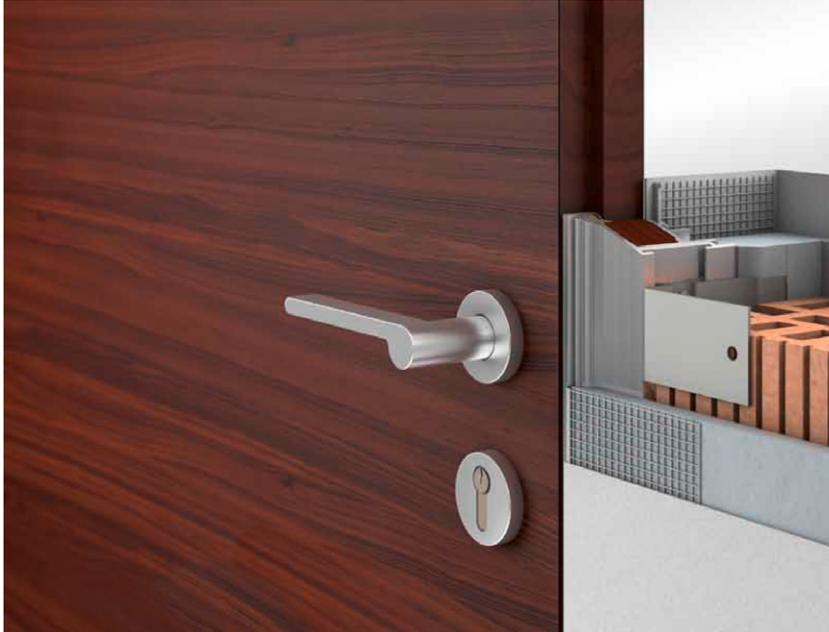
Spezielle Aluminiumprofile bieten eine perfekte Kantenausbildung für filigrane Schattenfugen. Das mitgelieferte Putznetz wird in das Zargenprofil eingeklickt und stellt somit eine feste Verbindung zwischen Tüorzarge und Mauerwerk/Trockenbau her. Verschraubbare Eckverbinder und Montagebügel sorgen für eine schnelle und fachgerechte Montage.
