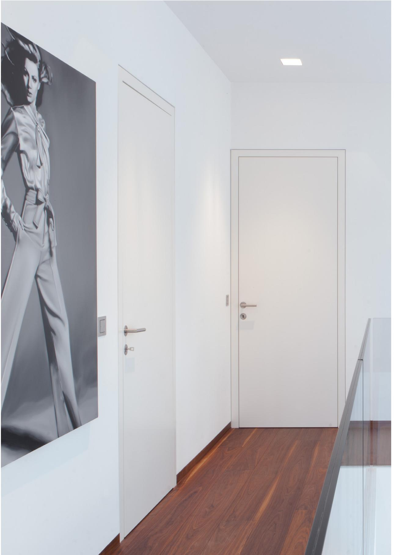
Modell FORMAT, wandbündige Umfassungszarge mit Grundzarge System TF und Schattennut Wandanschluss. Weißlack RAL 9010, flächenbündig einschlagend.
